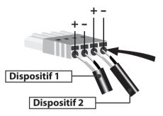
Vissez le câble dénudé sur lui-même et découpez-le avec des ciseaux afin qu'il soit introduit dans la fiche sans qu'il reste exposé et qu'il puisse générer des faux contacts avec d'autres câbles.
