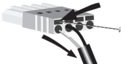
Ensuite, procédez de la même façon pour vos capteurs ou INPUTS. Tenez en compte que lorsque vous inversez la polarité d'un capteur, vous inverserez également les données enregistrées par TankBot. Vous pouvez inverser le sens de la polarité à partir du logiciel, sans que vous ayez à déposer le câblage.
