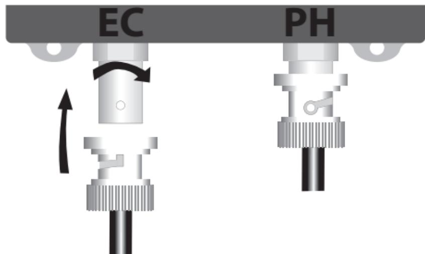
**N'inversez jamais la position des capteurs de pH et EC.**
