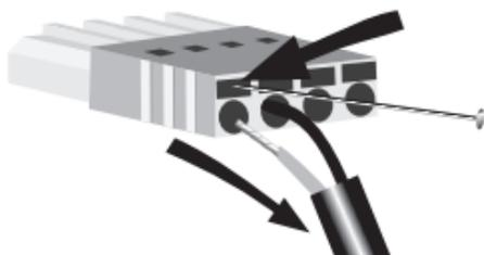
A continuación realice el mismo proceso con sus sensores o INPUTS. Tenga en cuenta que al invertir la polaridad de un sensor invertirá los datos registrados por TankBot. Puede invertir el sentido de polaridad desde el software sin necesidad de desmontar su cableado.
