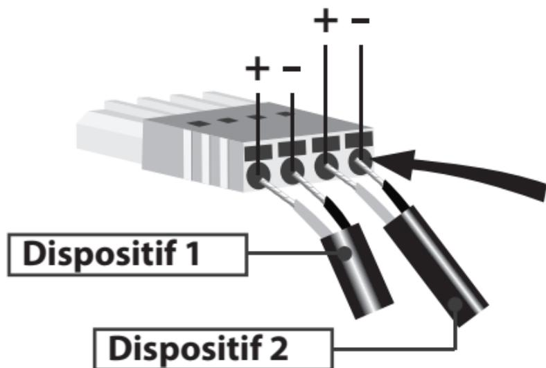
Vissez le câble dénudé sur lui-même et découpez-le avec des ciseaux afin qu'il soit introduit dans la fiche sans qu'il reste exposé et qu'il puisse générer des faux contacts avec d'autres câbles.
