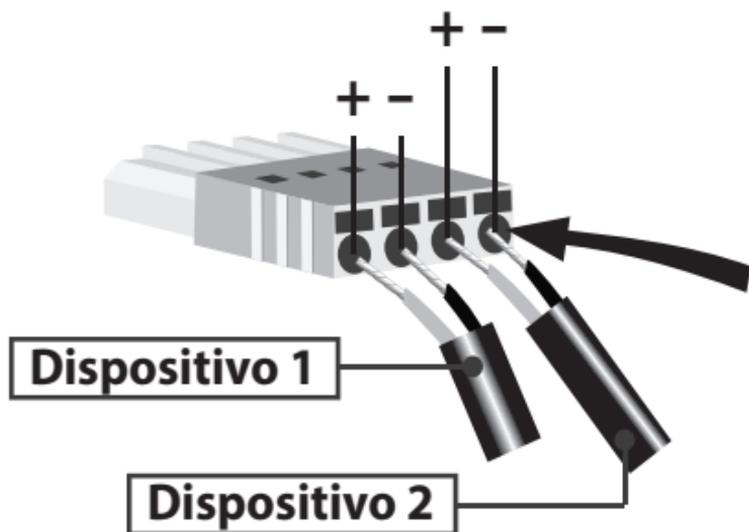
Gire el cable pelado sobre sí mismo y recórtelo con tijeras de forma que al introducirlo en el enchufe no quede el mismo expuesto pudiendo generar falsos contactos con otros cables.
