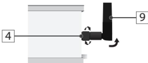
Sitúe el módulo en una superficie firme alejada de zonas propensas a inundaciones. Es recomendado fijar el módulo en un muro permaneciendo las perforaciones de anclaje en la parte superior.
