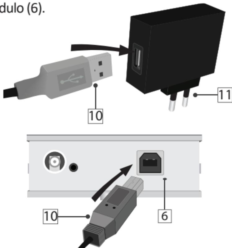
Conecte el transformador (11) a una toma de corriente de 110~230V<sub>AC</sub>/5V<sub>DC</sub>.
