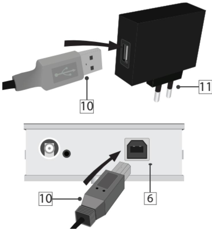
Connectez le transformateur (11) à une prise de courant de 110~230VAC/5VDC.
