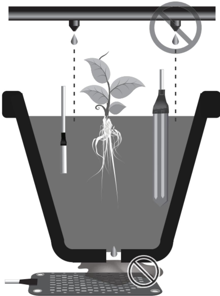
Les capteurs d'humidité du sol et les détecteurs d'inondations sont à technologie résistif et sont donc vulnérables à la corrosion issue de l'électrolyse.
