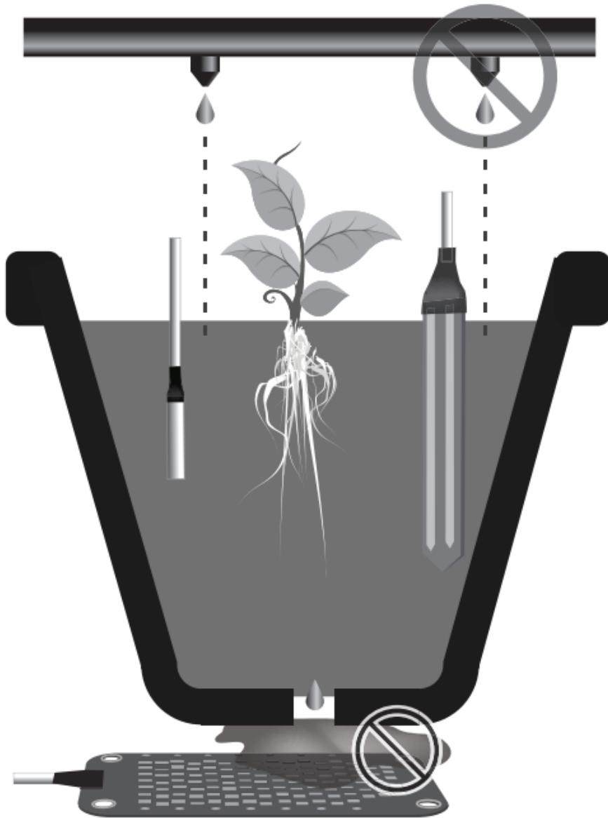
Los sensores de humedad para el sustrato y los detectores de inundaciones tienen tecnología resistiva siendo vulnerables a la corrosión provocada por la electrólisis.
