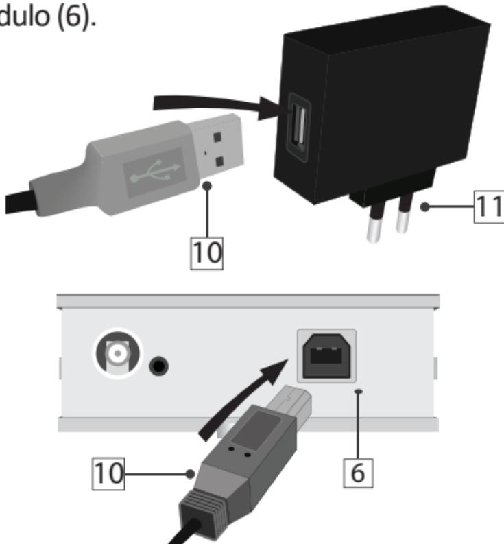
Conecte el transformador (11) a una toma de corriente de 110~230V<sub>AC</sub>/5V<sub>DC</sub>.
