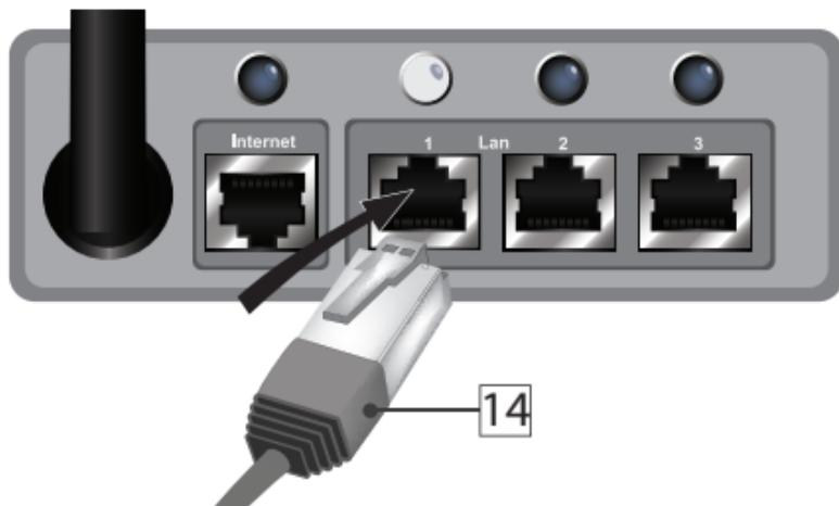
Si la conexión entre el módulo GroNode y su dispositivo de red se ha establecido correctamente, se habrán encendido un Led amarillo y otro verde en el puerto Ethernet de su GroNode.
