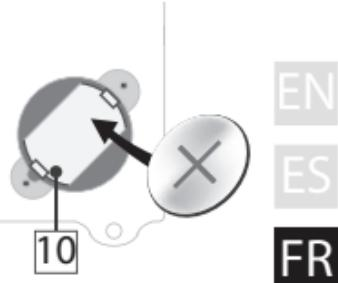
Placez le couvercle du compartiment à piles (15) sur le support de piles (10), puis insérez les vis (16) sans dépasser son réglage.
