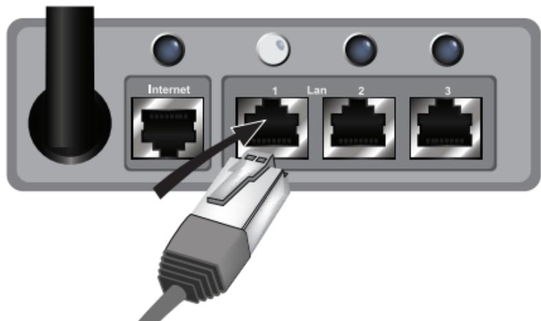
Si la connexion du module GroNode à votre dispositif de réseau a été faite correctement, un LED jaune et un autre vert s'allumeront au niveau du port Ethernet de votre GroNode.
